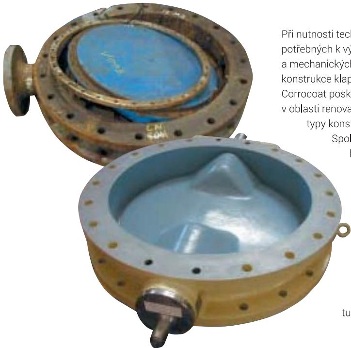
Při nutnosti technických zkušeností potřebných k výrobě vřeten, pouzder a mechanických těsnění pro všechny konstrukce klapkových uzávěrů, společnost Corrocoat poskytuje odborné služby v oblasti renovací a ochran pro všechny typy konstrukcí klapkových uzávěrů.
